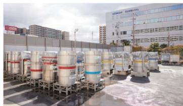
上/インキが入ったトートタンク。新聞社へ納入し印刷用に使われる。トートタンクはまた回収され、何度もリユースされる。右/ドラムクリッパーを装着したフォークリフトでドラム缶を運ぶ
