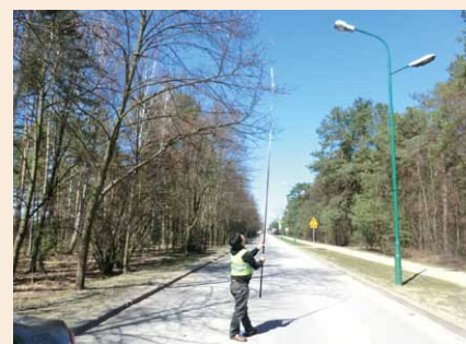
上空障害物の測量と輸送車両走行検討
