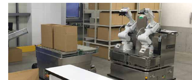
商品を棚から集品する自律移動型双腕ロボット(右)と搬送ロボット(左)による連携作業実証実験の様子
