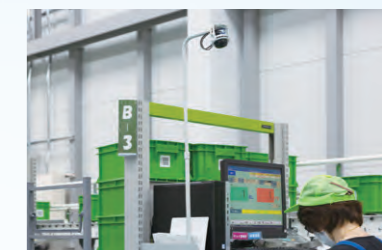
作業員の作業手順等を確認できる手元カメラ
