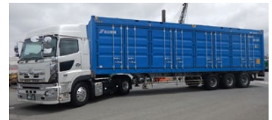
再生資源物輸送専用 40フィート特殊コンテナ (当社特許取得済)
