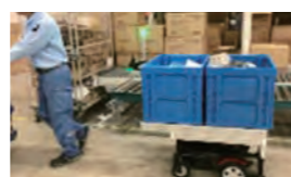
▲追従運搬ロボット(作業風景)
