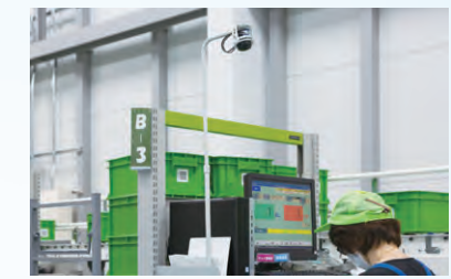
作業員の作業手順等を確認できる手元カメラ
