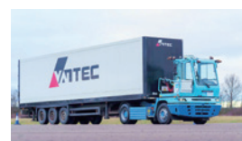
トレーラを牽引する電動トラック
