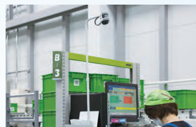
作業者の作業手順を確認できる 手元カメラ
