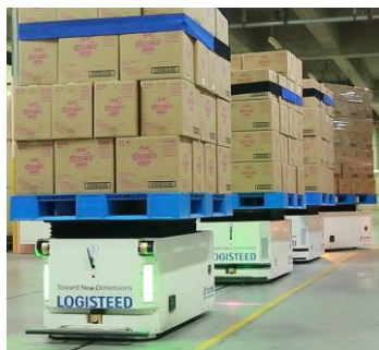
パレット搬送AGV 2020年6月～
