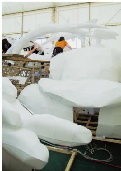
ねぶた小屋でのねぶた制作光景。ねぶた内部にはLED照明が使われている。針金での骨組み制作は4~5人のスタッフとともに行い、紙貼り作業では15~20人ほどのスタッフが手伝いに入る。バランスを見て、何度も調整が入る。色付けも複数回に分けて行う。
