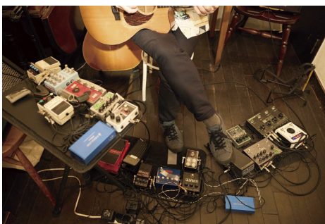
ファルコンさんが使うエフェクター。エフェクターとは音を加工して音響効果を生み出す機器で、さまざまな種類のものがある。
