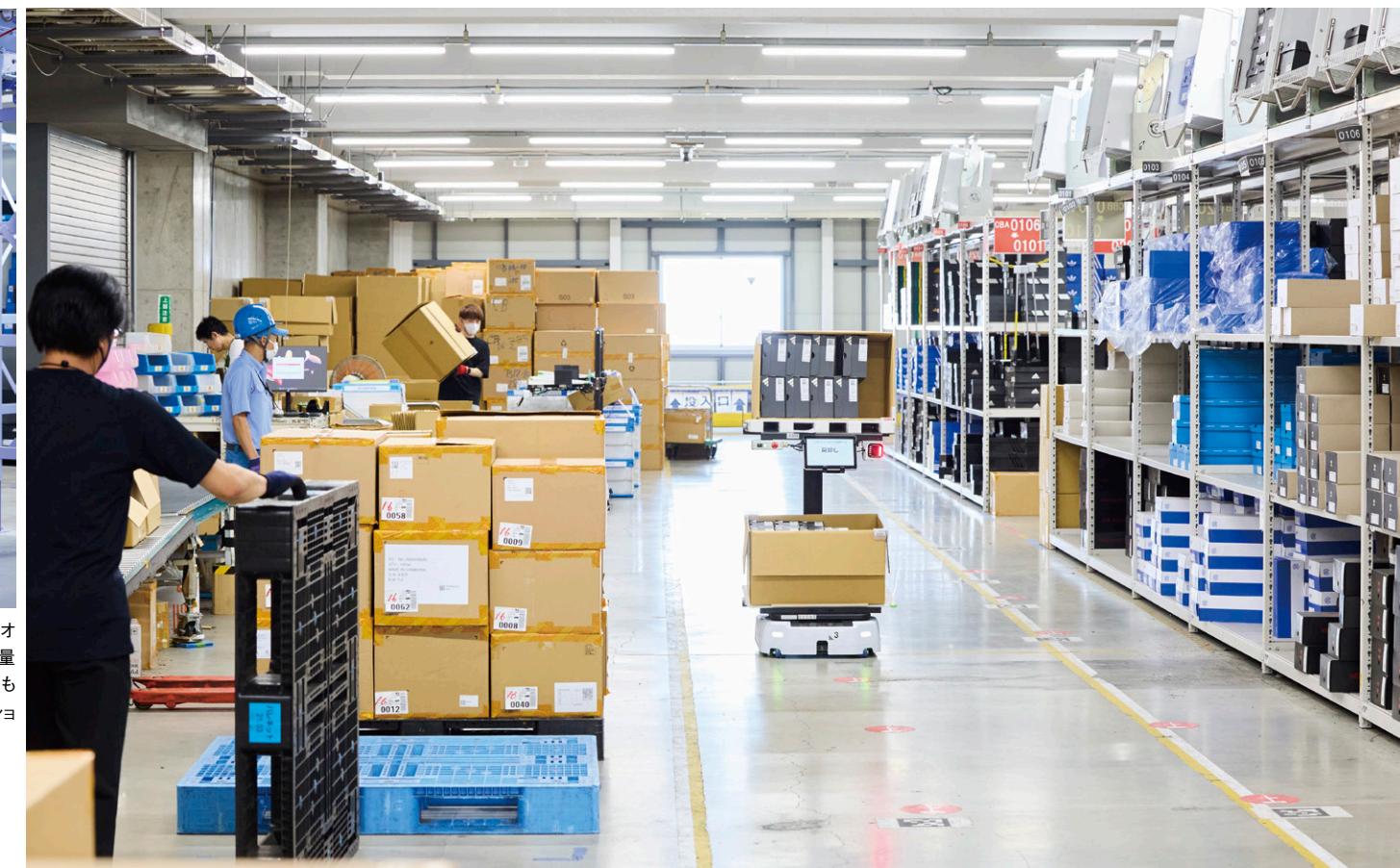
AutonMateの導入でピッキングの生産性は従来の約2倍に向上。倉庫内作業の省人化も実現した。
