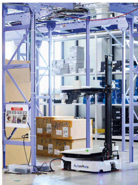
AutonMateは3時間の充電で8時間稼働する（高速充電オプションをつけた場合は1時間で充電可能）。最大積載重量は45キログラム（上段20キログラム、下段25キログラム）。もし、途中でバッテリー切れが起きても、手押しで充電ステーションまで簡単に運べる。
